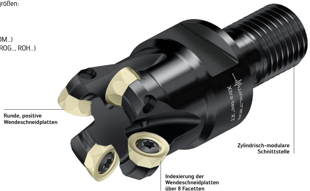
Xtra-tec® XT Rundplattenfräser M5468
