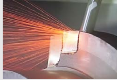
Keramik-Fräser im Einsatz: Blink-Bearbeitung (Plungen), Inconel
