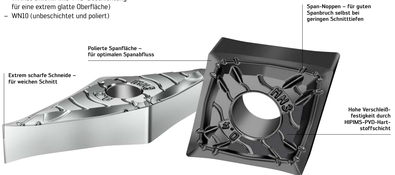
Doppelseitige Wendeschneidplatten-Geometrie MN3
