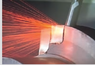
Keramik-Fräser im Einsatz: Blisk-Bearbeitung (Plungen), Inconel
